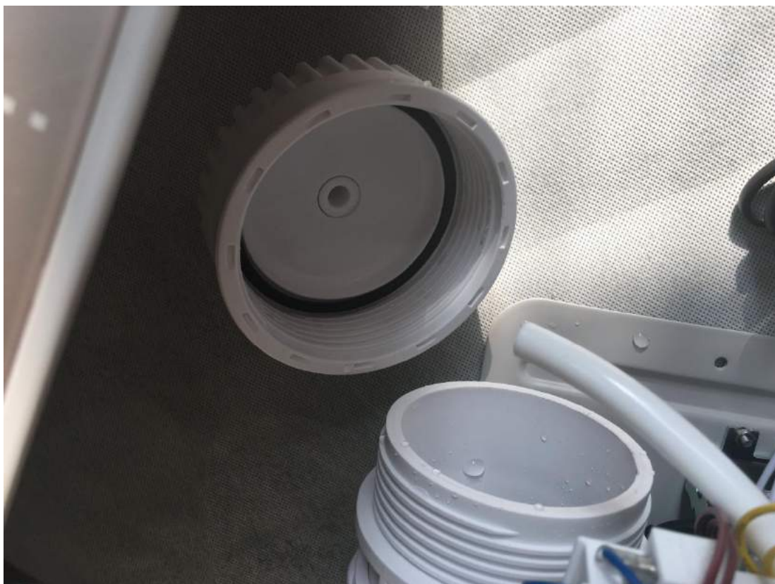
把 RO 膜的包装袋打开，安装 RO 膜时需要把有垫圈的一头朝里安装，如图：RO 膜的安装顺序和下图 RO 膜的摆放一致
